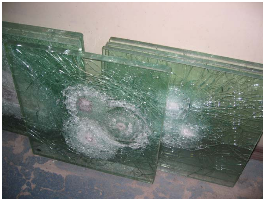
Бронированное стекло после испытаний
