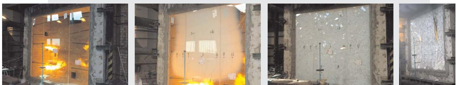
Испытания безрамной противопожарной перегородки
