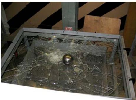
**стекла, бронированного защитной пленкой**, примерно одинаковые, но только инструменты взлома в этих случаях разные. В связи с такими высокими показателями **защитной пленки** к сопротивлению взлому, Управление Вневедомственной Охраны рекомендует нанесение **защитной пленки** на остекление периметра защищаемых этим учреждением объектов (например, банков). В отличие от решеток, **защитная пленка** не портит внешний вид фасада, витрин магазина, остекления банка, оконных проемов
