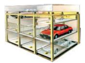
Внутри парковки паллеты с автомобилями помещаются вплотную друг к другу и с минимальными расстояниями между паллетами по высоте. Машиноместа в автоматической парковке (карусельной или элеваторной) рассчитаны на разные типы автомобилей: от малолитражек до минивэнов. Поскольку автоматическая парковка не содержит проходов для людей и проездов для автомобилей, строение автоматизированного
